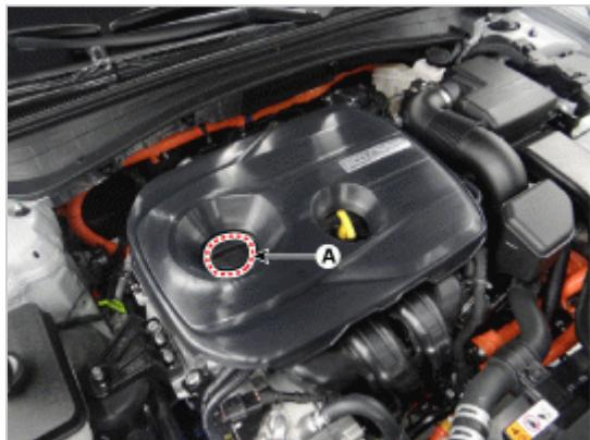
4. 起动发动机检查机油是否泄漏, 并检查机油表或油压警告灯。
